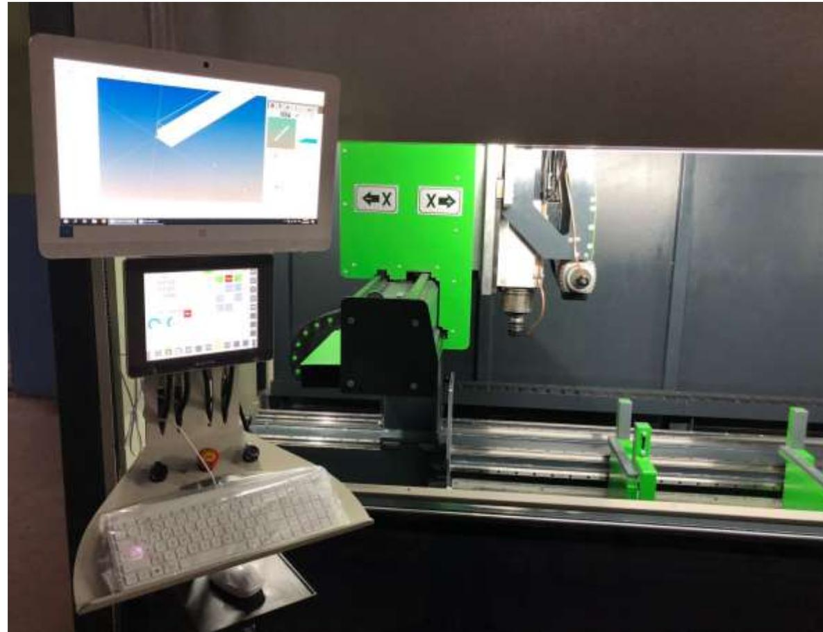
Le logiciel CamBOX 3D CADCAM est un outil personnalisé pour les centres d'usinage de profilés XC 2000. Il peut importer tous les fichiers DXF et les convertir en 3D, L'opérateur peut placer n'importe quel type d'opérations telles que perçage ou les opérations de fraisage indépendamment. **Compatible avec CHACAL.**
