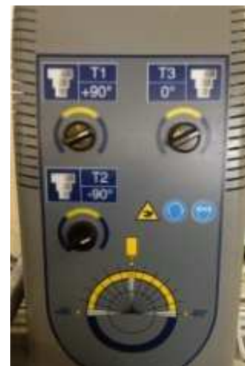
Pilotage des palpeurs pneumatiques en face avant
