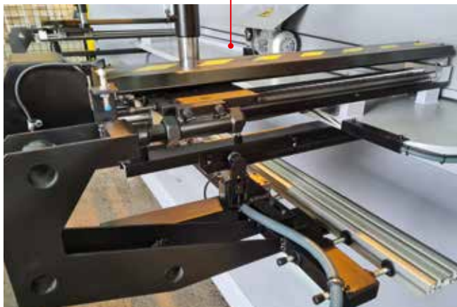
Guidage butée arrière avec capot de protection - axe X
